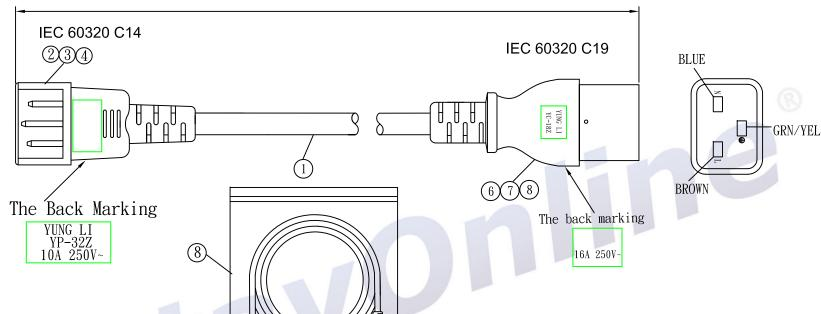
SPECIFICATION QTY REMARK NO. 1PC H05Z1Z1-F 1.0/3C BLACK LSZH 1 TER: 97606BS-1 2 2PCS 3 TER: 97607BS-1 1PC YP-33 INNER BODY LSZH 1PC 4 5 YP-33Z TPE PLASTIC:50P LSZH 32g/PC YC-18Z TPE PLASTIC 50P LSZH 18g/PC 6 YC-18 TER 3PCS 1PC YC-18 INNER BODY LSZH 8 1PC LOCK BAG: 250\*200\*0.04mm
